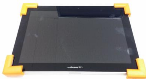
図 2. 発泡ゴム剤を装着したタブレット機器
