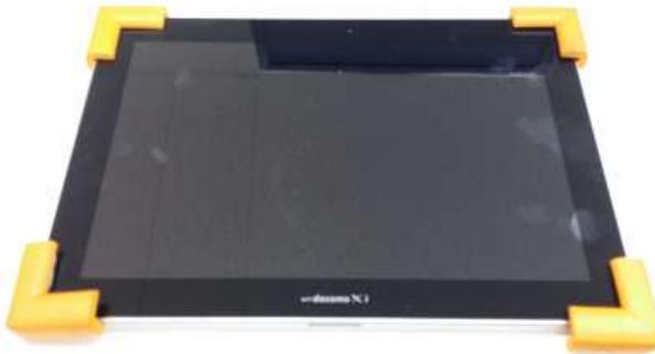
図 11 発泡ゴム剤を装着したタブレット機器
