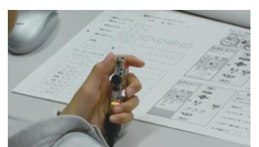
▲「計測制御プログラマー」の基板には、照度センサー、温度センサー、LED、ブザーなどが組み込まれている。
