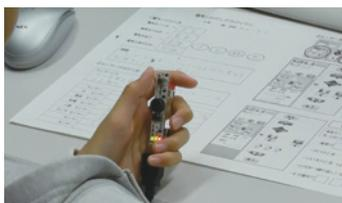
▲ 「計測制御プログラマー」の基板には、照度センサー、温度センサー、LED、プザーなどが組み込まれている。
